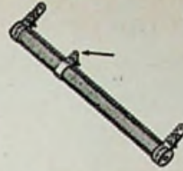
DRAADGEWONDEN WEERSTAND, met verplaatsbare aftakkleem.
